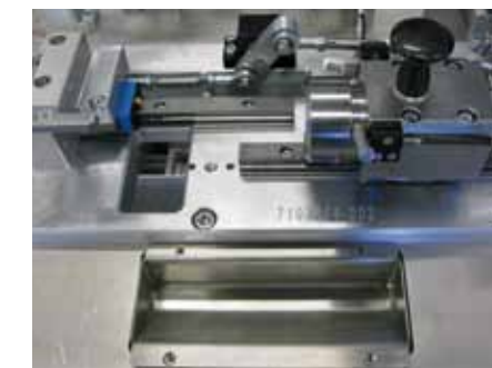
Montagevorrichtung für das Justieren von Stellmotoren.
