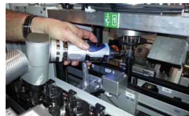
Die mobile 3D-Messtechnik kann auch zur Fehlersuche eingesetzt werden und ermittelt markante Faktoren wie Koaxialität und Parallelität.
